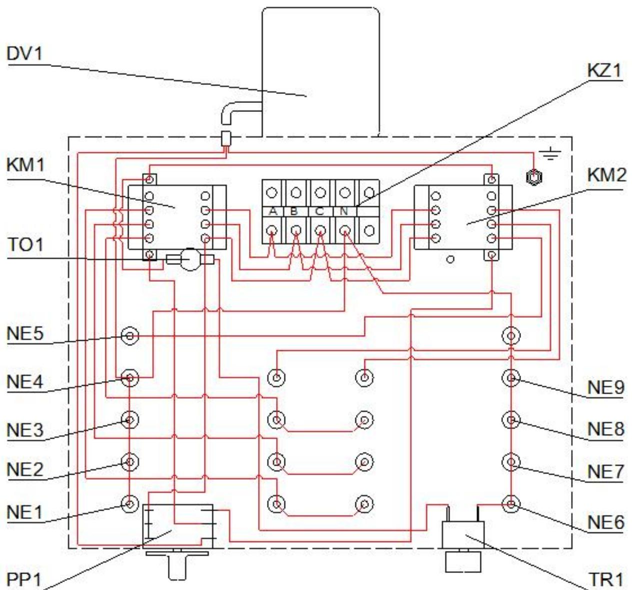
**Рисунок 3.** Схема электрическая монтажная тепловентилятора СКИФ-12.
