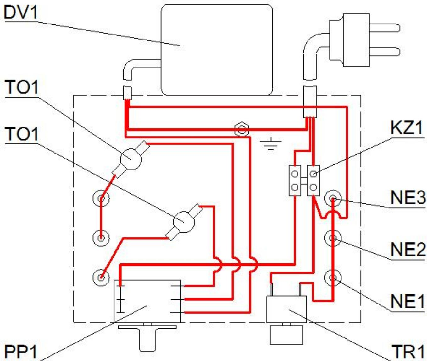
*Рисунок 1. Схема электрическая монтажная тепловентилятора СКИФ-3.*
