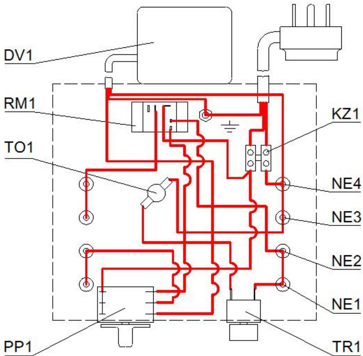
**Рисунок 2.** Схема электрическая монтажная тепловентилятора СКИФ-5.
